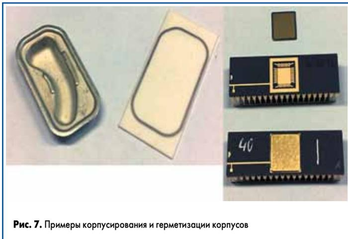
**Рис. 7.** Примеры корпусирования и герметизации корпусов
