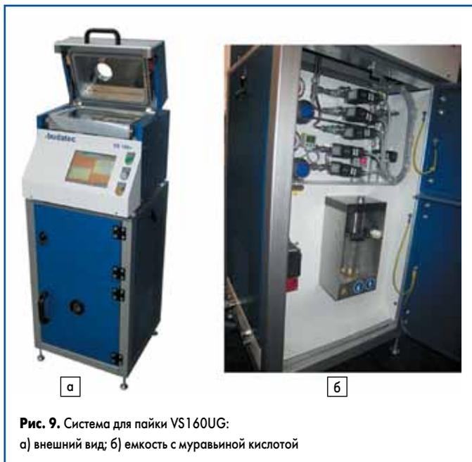
Рис. 9. Система для пайки VS160UG:
