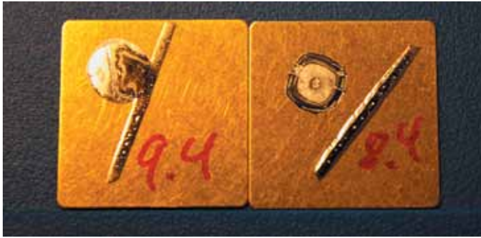
Рис. 2. Коваровые крышки с Ni/Au, круглой PbSn(5) и стержневой формы AuSn(20)
