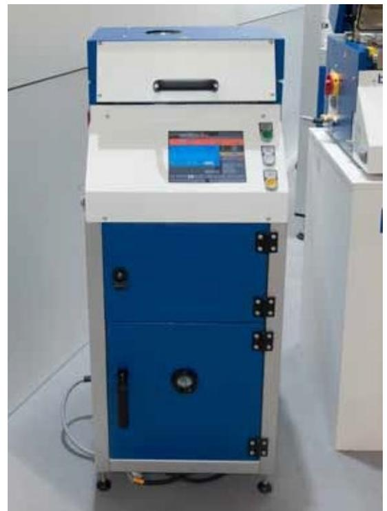
удаление оксидных пленок и т.д. Такая технология используется не только в микроэлектронике, она все активнее применяется для различных задач сборки электронных узлов, где нельзя применять пайку с флюсом. Плазменная очистка не только существенно улучшает качество последующей пайки, но и не повреждает уже установленные компоненты.
